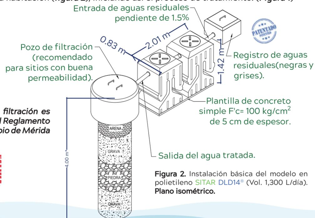
Figura 2. Instalación básica del modelo en polietileno SITAR DLD14® (Vol. 1,300 L/día). Plano isométrico.
